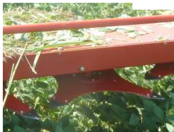
Fig. 5. Organi di taglio della cimatrice. Dettaglio
